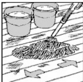
2. Humidifier la surface dans les sens des fibres du bois à l'aide d'un balai bien essorée.
