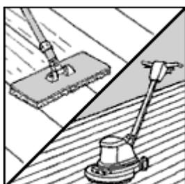
3. Nettoyer la surface profondément à l'aide du mono brosse avec le feutre à polir beige (selon le degré, utiliser le feutre à polir noire) ou manuellement avec le support pour manche avec un bloc à polir.
